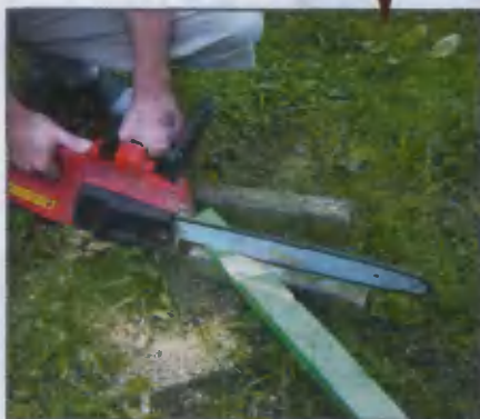
При изготовлении пазов после тщательной разметки в несколько этапов я выбирал древесину цепной пилой
